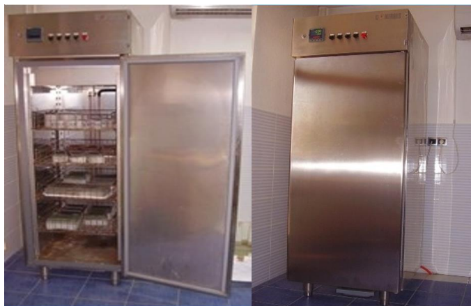
Sl. 3. Komora za hlađenje sa uzorcima postavljenim u rad
